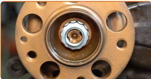
**57** Schrauben Sie die Nabenmutter an. Verwenden Sie Stecknuss Nr. 30. Verwenden Sie einen Ratschenschlüssel.
