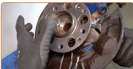
**43** Die Keilwellen des CV-Gelenks der Antriebswelle reinigen. Benutzen Sie eine Drahtbürste. Benutzen Sie WD-40-Spray.
