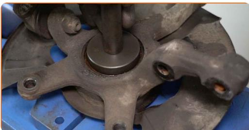
**38** Reinigen Sie den Einbauort für die Nabenlagerung. Benutzen Sie eine Drahtbürste. Benutzen Sie WD-40-Spray.
