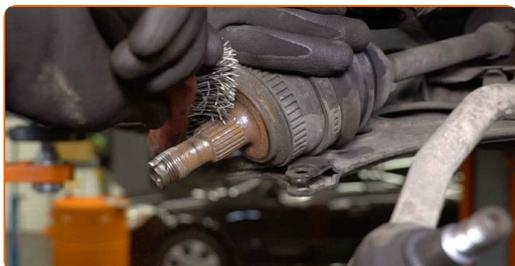
**44** Installieren Sie den Achsschenkel mit einer Nabe. Bauen Sie die Antriebswelle ein.
