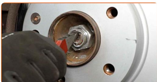
**8** Reinigen Sie das Befestigungselement der Radnabe. Benutzen Sie eine Drahtbürste. Benutzen Sie WD-40-Spray.
