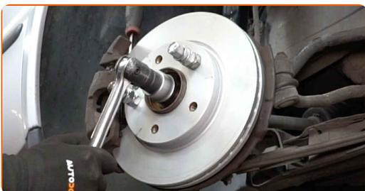
**10** Trennen Sie die Antriebswelle vom Achsschenkel. Verwenden Sie einen Splintentreiber. Benutzen Sie einen Hammer.
