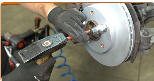
**11** Entfernen Sie die Befestigungsmutter.
