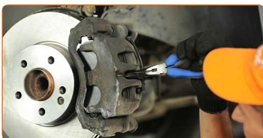
**36** Installieren Sie die Staubschutzkappen der Bremssattel-Führungsstifte. Verwenden Sie einen flachen Schraubendreher.
