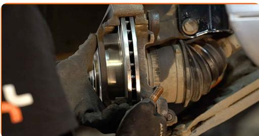
**26** Befestigen Sie die Bremssattelhalterung. Verwenden Sie Stecknuss Nr. 21. Verwenden Sie einen Drehmomentschlüssel. Ziehen Sie ihn mit 172 Nm Drehmoment fest.
