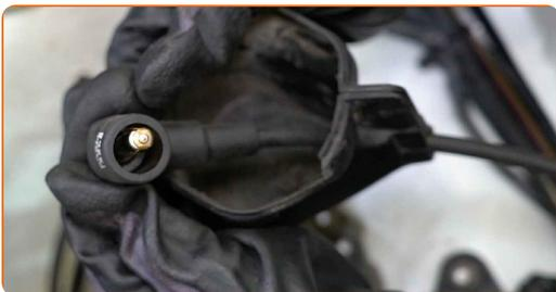
**19** Schließen Sie das Hochspannungskabel an die Zündspule an.
