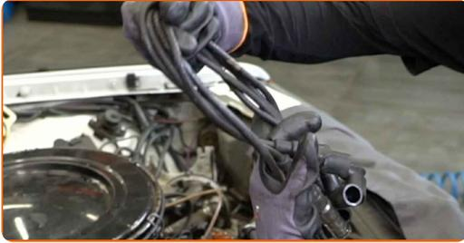
**12** Reinigen Sie die Anschlüsse des Zündverteilers. Benutzen Sie eine Drahtbürste. Verwenden Sie dielektrisches Fett.
