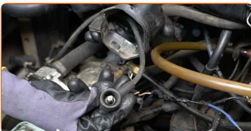
**17** Entfernen Sie das Hochspannungskabel von der Zündspulenabdeckung. Benutzen Sie ein Brecheisen.
