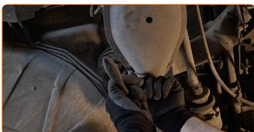
**7** Entfernen Sie die Kunststoffabdeckung des Querlenkers.
