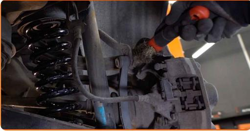
**9** Trennen Sie den Querstabilisator von der Verbindung. Verwenden Sie Ring-Gabelschlüssel Nr. 17. Verwenden Sie Ring-Gabelschlüssel Nr. 19.
