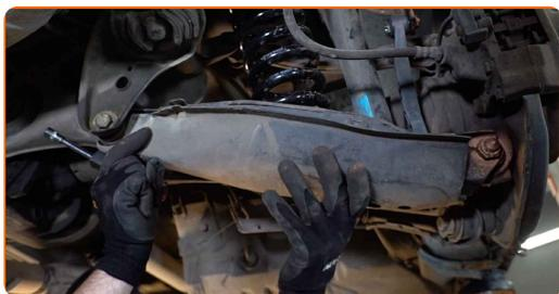
**18** Schrauben Sie die Befestigungen der Kunststoffabdeckung des Querlenkers ein. Verwenden Sie Stecknuss Nr. 10. Verwenden Sie einen Ratschenschlüssel.
