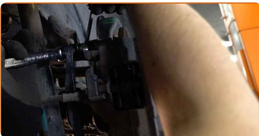
**10** Schrauben Sie das Befestigungselement heraus, das die Druckstange mit dem Stabilisator verbindet. Verwenden Sie Ring-Gabelschlüssel Nr. 13 (2 Teile).
