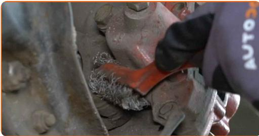
**14** Schrauben Sie die Befestigungen des Bremssattels ab. Verwenden Sie Ring-Gabelschlüssel Nr. 17.
