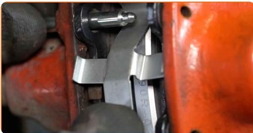
**33** Montieren Sie die Führungsbolzen der Bremsbeläge. Verwenden Sie einen Splintentreiber. Benutzen Sie einen Hammer.
