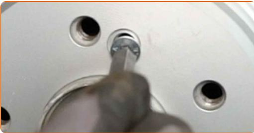
**26** Schrauben Sie die Befestigungen der Bremsscheibe fest. Verwenden Sie Inbusschlüssel Nr. H5. Verwenden Sie einen Drehmomentschlüssel. Ziehen Sie ihn mit 10 Nm Drehmoment fest.
