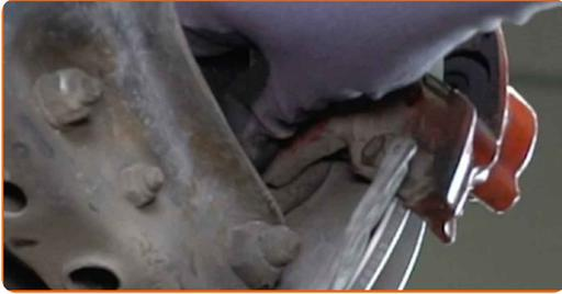
**30** Ziehen Sie die Bremssattelbefestigungen fest. Verwenden Sie Stecknuss Nr. 17. Verwenden Sie einen Drehmomentschlüssel. Ziehen Sie ihn mit 65 Nm Drehmoment fest.
