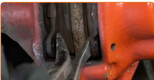
**12** Entfernen Sie die Bremsbeläge.
