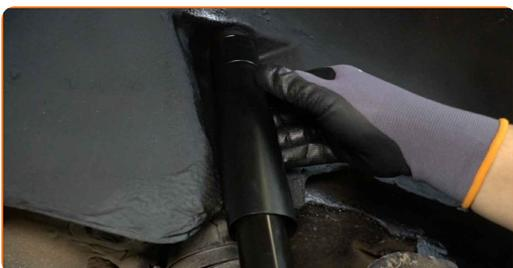
**40** Montieren Sie die Elemente der oberen Befestigung des Stoßdämpfers.
