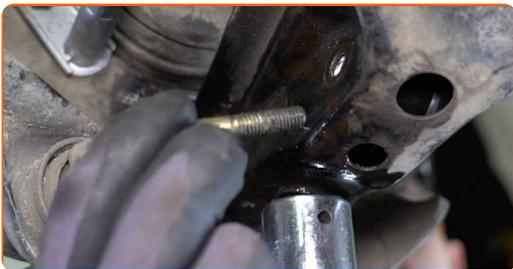
**22** Lösen Sie die Koppelstange vom Achslenker.
