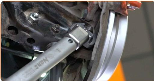
**45** Schrauben Sie die Befestigung fest, die den Querlenker mit dem Hilfsrahmen verbindet. Verwenden Sie Ring-Gabelschlüssel Nr. 19. Verwenden Sie Stecknuss Nr. 19. Verwenden Sie einen Drehmomentschlüssel. Ziehen Sie ihn mit 70 Nm Drehmoment fest.
