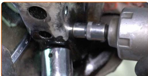
**21** Entfernen Sie die Befestigungsschraube.
