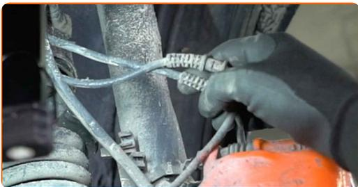
**11** Lockern Sie die untere Befestigung am Stoßdämpfer. Verwenden Sie Stecknuss Nr. 19. Verwenden Sie einen Ratschenschlüssel.
