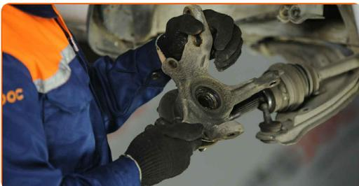
**24** Entfernen Sie die innere Öldichtung des Radlagers. Verwenden Sie einen flachen Schraubendreher.
