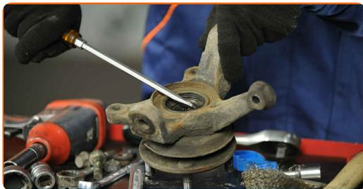
**25** Entfernen Sie die Radnabe vom Achsschenkel. Verwenden Sie einen Druckstücksatz mit Ein-/Auspresswerkzeug. Benutzen Sie einen Hammer.
