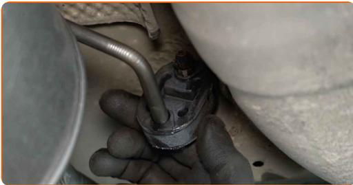
**14** Ziehen Sie die Schelle des Endschalldämpfers fest. Verwenden Sie Stecknuss Nr. 13. Verwenden Sie einen Ratschenschlüssel.
