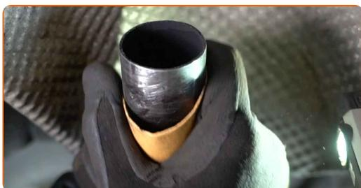
**11** Montieren Sie einen neuen Endschalldämpfer.
