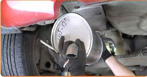
**12** Befestigen Sie den Endschalldämpfer am Auspuffrohr.
