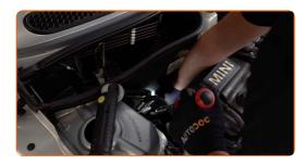
Entfernen Sie die Öleinfüllschraube.
