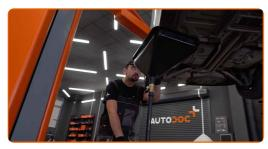
Drehen Sie die Ablassschraube heraus. Verwenden Sie Stecknuss Nr. 13. Verwenden Sie einen Ratschenschlüssel.
