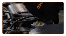
Schrauben Sie den Filtergehäusedeckel zusammen mit dem alten Filterelement ab. Verwenden Sie Steckschlüssel 76-14F. Verwenden Sie einen Ratschenschlüssel.
