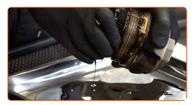
Den Dichtungsring des Ölfilterdeckels entfernen.
