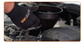
Füllen Sie Öl durch den Einfüllstutzen in den Motor. Erforderliche Menge an Öl: 4.8 l.
