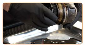
Installieren Sie einen neuen Dichtungsring an seinem Montagesitz auf der Filterabdeckung.
