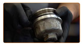
Setzen Sie den neuen Ölfilter in den Montagesitz auf der Filterabdeckung ein.
