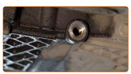
Schrauben Sie die neue Ablassschraube ein und ziehen Sie sie fest. Verwenden Sie Stecknuss Nr. 13. Verwenden Sie einen Drehmomentschlüssel. Ziehen Sie ihn mit 25 Nm Drehmoment fest.
