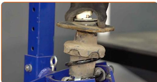
**16** Ziehen Sie die Federbeinkolbenstangenmutter an. Verwenden Sie Inbusschlüssel Nr. H6. Verwenden Sie Ring-Gabelschlüssel Nr. 19. Verwenden Sie einen Drehmomentschlüssel. Ziehen Sie ihn mit 30 Nm Drehmoment fest.
