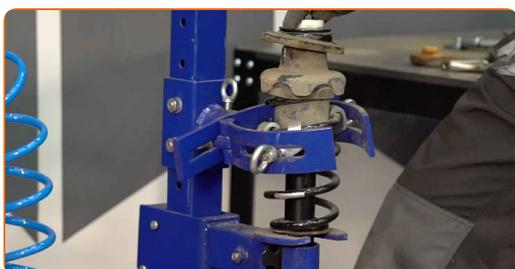
**18** Entfernen Sie das zusammengebaute Federbein.
