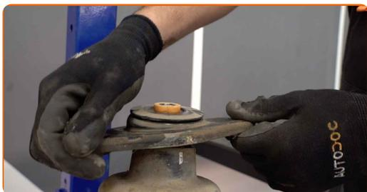
**15** Installieren Sie die obere Federbein montieren.
