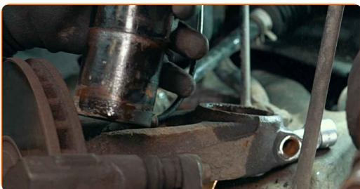
**31** Schrauben Sie das obere Befestigungselement des Federbeins ab (3 Stück).
