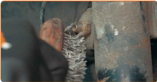
**14** Schrauben Sie das Befestigungselement heraus, das die Druckstange mit dem Federbein verbindet. Verwenden Sie Stecknuss Nr. 17. Verwenden Sie einen Ratschenschlüssel.
