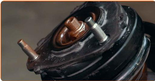
**52** Installieren Sie das Federbein am Radlauf.
