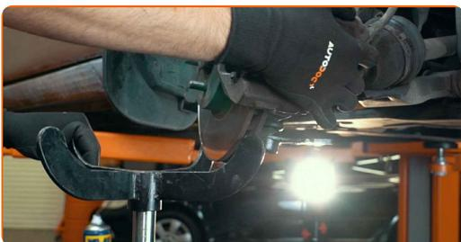
**29** Lösen Sie das untere Befestigungselement, dass das Federbein mit dem Achsschenkel verbindet. Verwenden Sie eine spezielle Schraubnuss, um den Stoßdämpfer zu entfernen. Verwenden Sie einen Ratschenschlüssel.
