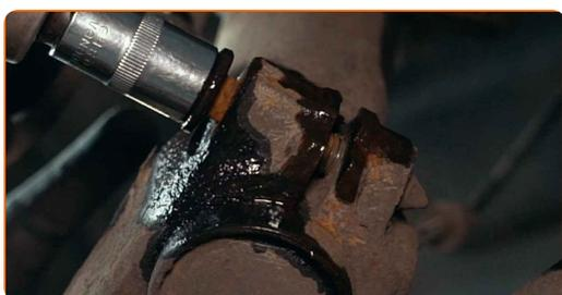
**20** Entfernen Sie die Befestigungsschraube.
