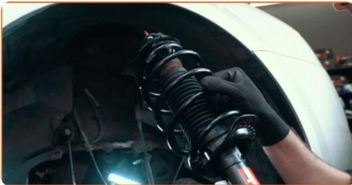
**53** Sichern Sie die oberen Befestigungen des Federbeines (3 Stück). Schrauben Sie diese nicht fest.
