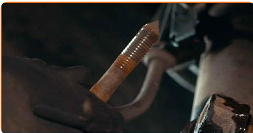
**21** Lösen Sie das Befestigungselement, welches die Antriebswelle mit der Radnabe verbindet. Verwenden Sie Stecknuss Nr. 32. Verwenden Sie einen Ratschenschlüssel.
