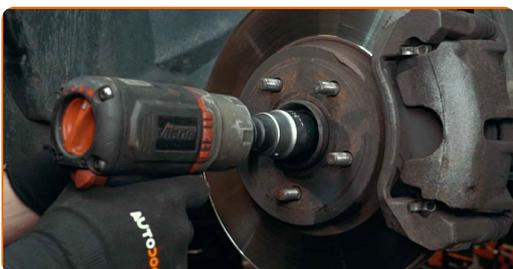
**22** Entfernen Sie die Befestigungsmutter.
