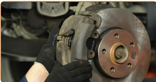
**33** Behandeln Sie die Bremssattel-Führungsstifte. Verwenden Sie das Bremssattelführungsbolzen-Fett.
