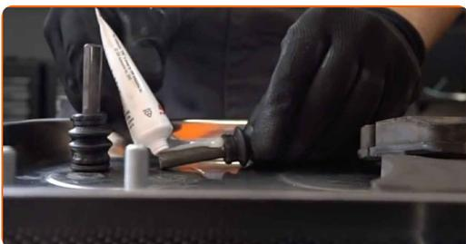
**34** Montieren Sie die Bremssattelführungsbolzen.
