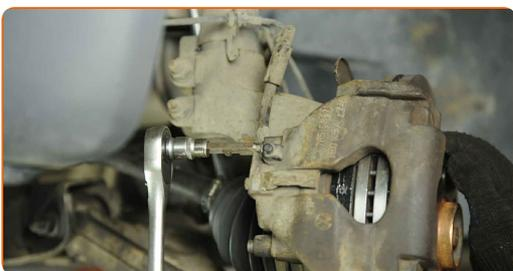
**36** Installieren Sie die Staubschutzkappen der Bremssattel-Führungsstifte.
