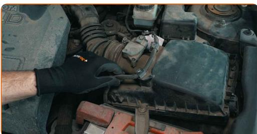
8 Sorgen Sie dafür, dass kein Schmutz in das Luftfiltergehäuse gelangt
