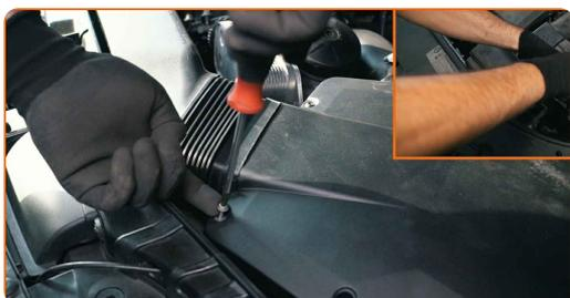
**13** Entfernen Sie die Abdeckung, drücken Sie den Filter nach oben und nehmen Sie ihn heraus
