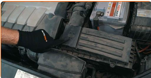
6 Die Gehäuseabdeckung kann mit Clips oder Schrauben befestigt sein
