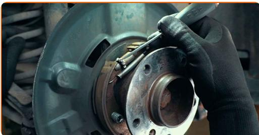
**8** Das Einstellritzel ist über das Radschraubenloch oder die Nabenbohrung zugänglich
