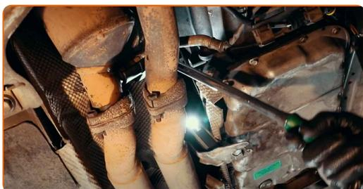
**6** Schmieren Sie das Gewinde der neuen Sonde mit einem speziellen Schmiermittel ein, z. B. Hochtemperatur-Kupferfett.
