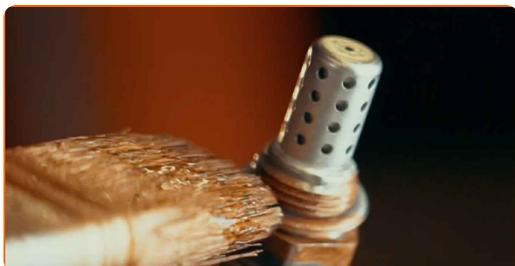
**7** Schrauben Sie die Sonde von Hand bis zum Anschlag ein.
