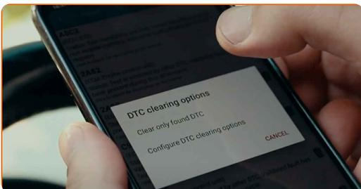
**13** In einigen Fällen müssen Sie eine gewisse Strecke fahren, damit sich das Steuergerät auf die neue Sonde einstellen kann.
