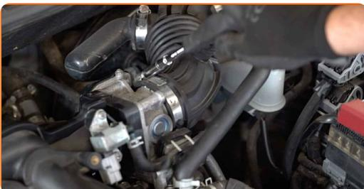
**5** Trennen Sie das Luftansaugrohr vom Luftfilter-Gehäuse.
