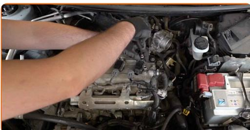
**15** Entnehmen Sie die Zündspule aus der Vertiefung für die Zündkerze.
