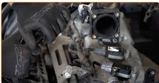
**25** Ziehen Sie die Ansaugkrümmer Befestigungen fest. Verwenden Sie Stecknuss Nr. 10. Verwenden Sie einen Drehmomentschlüssel. Ziehen Sie ihn mit 27 Nm Drehmoment fest.
