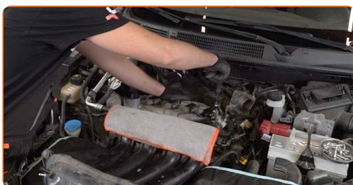
**20** Schließen Sie den Anschluss der Zündspule an.
