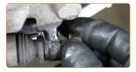
Entfernen Sie den Bremssattel.
