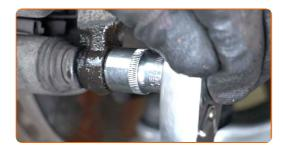
Entfernen Sie die Befestigungsschrauben.
