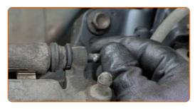
Ziehen Sie die Bremssattelbefestigungen fest. Verwenden Sie Stecknuss Nr. 14. Verwenden Sie einen Drehmomentschlüssel. Ziehen Sie ihn mit 32 Nm Drehmoment fest.
