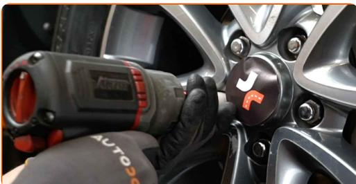
**22** Senken Sie das Auto und ziehen Sie die Radschrauben über Kreuz an. Verwenden Sie eine Schlagnuss für Felgen # 21. Verwenden Sie einen Drehmomentschlüssel. Ziehen Sie ihn mit 118 Nm Drehmoment fest.
