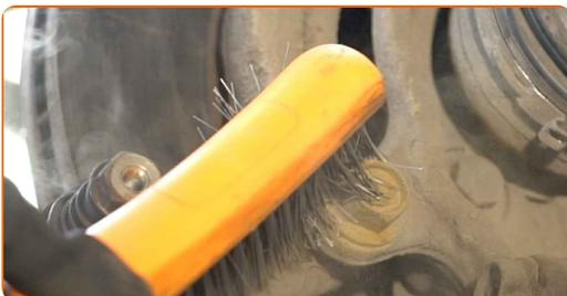
**13** Lösen Sie die Befestigung der Sattelhalterung. Verwenden Sie Stecknuss Nr. 19. Verwenden Sie ein Windeisen.
