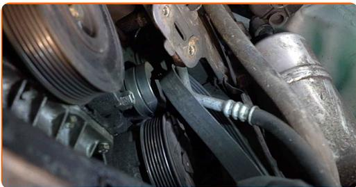
Austausch: Keilriemen – NISSAN TIIDA Schrägheck (C12). Tipp von AUTODOC:
