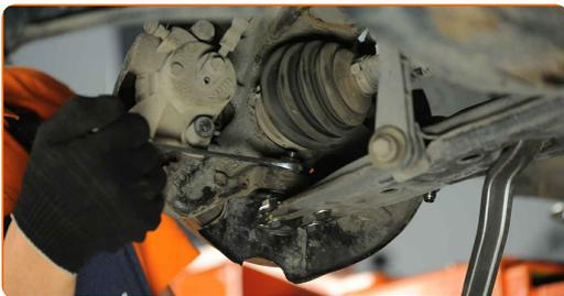
24 Installieren Sie die Stabbefestigung am Stabilisator und ziehen Sie diese an. Verwenden Sie Stecknuss Nr. 16. Verwenden Sie einen Drehmomentschlüssel. Ziehen Sie ihn mit 15 Nm Drehmoment fest.+90°
