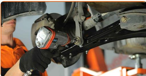
25 Die Antriebswelle in die Radnabe installieren.
