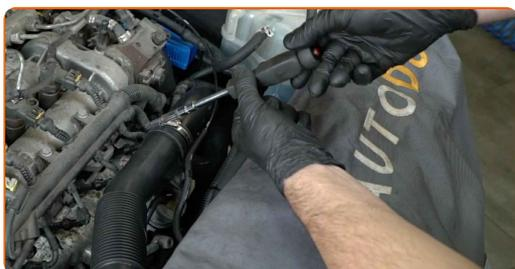
**11** Ziehen Sie die Lufteinlassrohrbefestigung ab. Verwenden Sie den Torx T25. Verwenden Sie einen Ratschenschlüssel.
