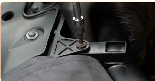
**38** Entfernen Sie die Öleinfüllschraube.
