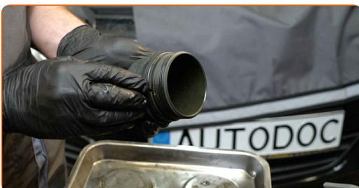
**24** Setzen Sie den neuen Ölfilter in den Montagesitz auf der Filterabdeckung ein.
