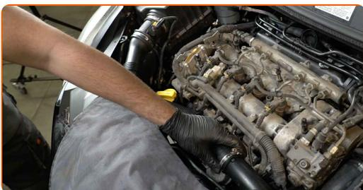
**36** Ziehen Sie die Klemme am Luftansaugschlauch fest. Verwenden Sie Stecknuss Nr. 7. Verwenden Sie einen Ratschenschlüssel.
