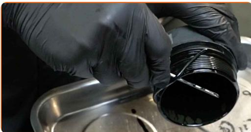
**22** Reinigen Sie den Deckel des Ölfilter-Gehäuses. Verwenden Sie Allzweckreinigungsspray.
