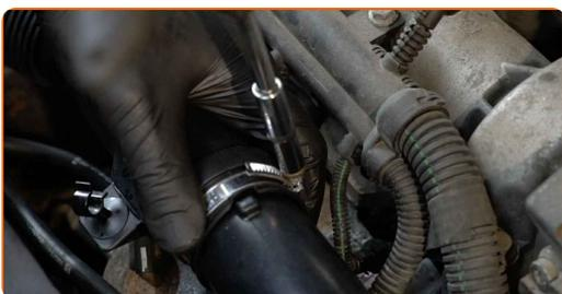
**37** Schrauben Sie das Befestigungselement des Luftansaugrohrs ein. Verwenden Sie den Torx T25.
