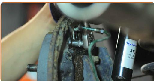
**18** Bringen Sie die Bremsleitung an. Verwenden Sie einen offenen Ringschlüssel #10.
