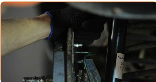
**19** Entlüften Sie das Bremszylindersystem. Verwenden Sie Ring-Gabelschlüssel Nr. 9.
