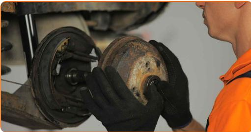
**Austausch: Radbremszylinder – OPEL Astra F Limousine (T92). Fachleute empfehlen:**
