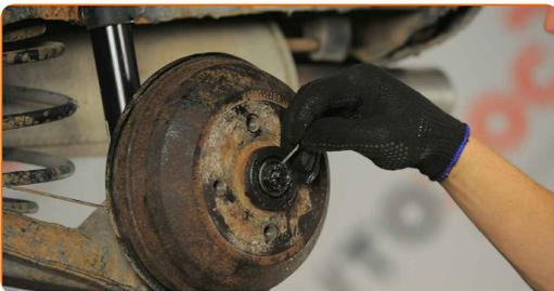
**25** Installieren Sie die Schutzkappe des Nabenlagers. Verwenden Sie einen Gummi-Hammer.
