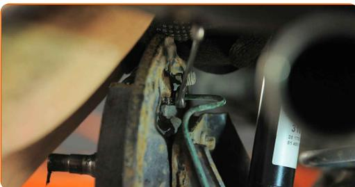
**Austausch: Radbremszylinder – OPEL Astra F Limousine (T92). AUTODOC empfiehlt:**
