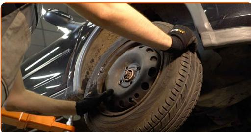
**Austausch: Radbremszylinder – OPEL Astra F Limousine (T92). AUTODOC-Experten empfehlen:**
