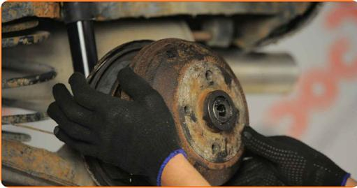
**23** Schrauben Sie die Befestigung der Radnabe ein. Verwenden Sie Ring-Gabelschlüssel Nr. 24. Verwenden Sie einen Ratschenschlüssel.
