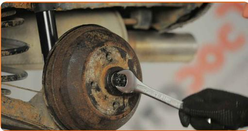
**24** Installieren Sie den Splint der Nabe an der Lagerbefestigungsmutter. Verwenden Sie eine Rundzange.
