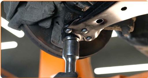
**22** Schrauben Sie die Befestigungen des Kugelgelenks ein. Verwenden Sie Ring-Gabelschlüssel Nr. 18. Verwenden Sie Stecknuss Nr. 18. Verwenden Sie einen Ratschenschlüssel.
