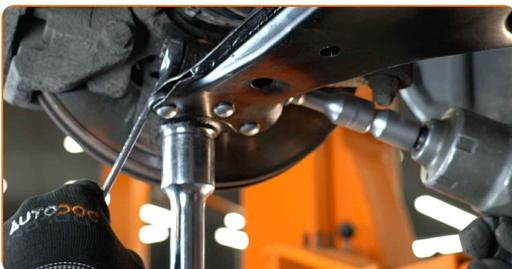
**23** Schrauben Sie die vordere Armbefestigung an. Verwenden Sie Ring-Gabelschlüssel Nr. 18. Verwenden Sie Stecknuss Nr. 18. Verwenden Sie ein Windeisen.
