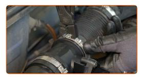
Schrauben Sie die Befestigungsklemme ein, die das Luftkanal-Gehäuse mit dem Luftfilter-Gehäuse verbindet. Verwenden Sie einen Kreuzschlitzschraubendreher.
