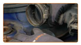
Lösen Sie die Klemmen, mit denen der Luftmassenmesser an den Luftschläuchen befestigt ist. Verwenden Sie einen flachen Schraubendreher.
