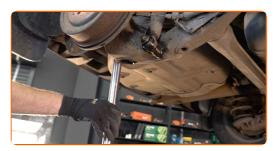
Schrauben Sie den unteren Befestiger des Stoßdämpfers ab. Verwenden Sie Stecknuss Nr. E20. Verwenden Sie ein Windeisen.
