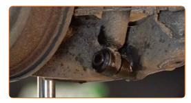
Schrauben Sie das obere Befestigungselement des Stoßdämpfers ab. Verwenden Sie Stecknuss Nr. E20. Verwenden Sie ein Windeisen.
