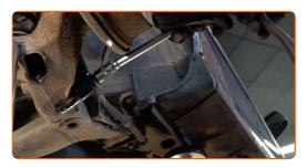
Heben Sie den hydraulischen Getriebeheber um 10–15 cm an. Benutzen Sie einen hydraulischen Getriebeheber.
