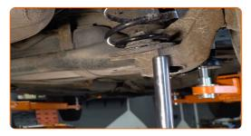
Ziehen Sie die obere Stoßdämpferbefestigung an. Verwenden Sie Stecknuss Nr. E20. Verwenden Sie einen Drehmomentschlüssel. Ziehen Sie ihn mit 90 Nm Drehmoment fest.
