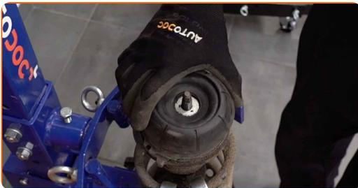
24 Bringen Sie das neue Stützlager, die Manschette und den Anschlagpuffer am Stoßdämpfer an.
