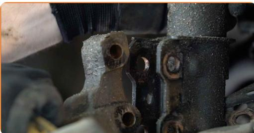
**18** Schrauben Sie die untere Befestigung der Stoßdämpferstrebe ab. Verwenden Sie Ring-Gabelschlüssel Nr. 17. Verwenden Sie Stecknuss Nr. 9.
