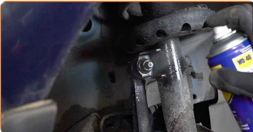
12 Schrauben Sie die Mutter ab und entfernen Sie die Stabilisatorstange aus dem Federbein. Verwenden Sie Ring-Gabelschlüssel Nr. 19. Verwenden Sie Stecknuss Nr. 18. Verwenden Sie einen Ratschenschlüssel.
