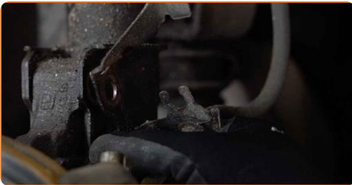
**17** Ziehen Sie den Achsschenkel vom Dämpferbein ab. Benutzen Sie ein Brecheisen.
