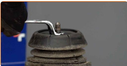
23 Entfernen Sie die Stoßdämpferhalterung, die Manschette und den Stoßstopp. Benutzen Sie ein Brecheisen.
