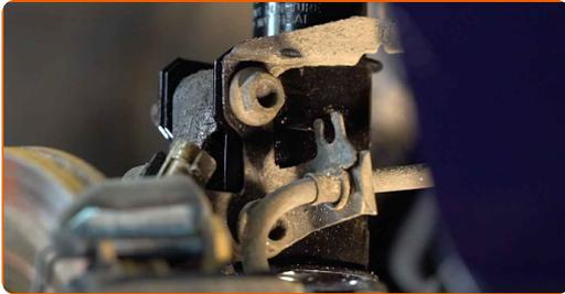
**37** Befestigen Sie die Stabilisatorverbindung am Federbein. Verwenden Sie Ring-Gabelschlüssel Nr. 19. Verwenden Sie Stecknuss Nr. 18. Verwenden Sie einen Drehmomentschlüssel. Ziehen Sie ihn mit 65 Nm Drehmoment fest.
