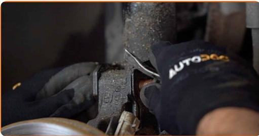
**16** Trennen Sie den Bremsschlauchhalter vom Dämpferbein. Verwenden Sie einen flachen Schraubendreher.
