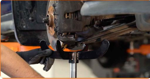
**15** Entfernen Sie das Befestigungselement, mit dem der Bremsschlauch am Federbein befestigt ist.
