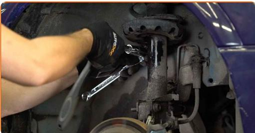
13 Schrauben Sie das untere Befestigungselement ab, dass das Federbein mit dem Achsschenkel verbindet. Verwenden Sie Ring-Gabelschlüssel Nr. 18. Verwenden Sie Stecknuss Nr. 18. Verwenden Sie ein Windeisen.
