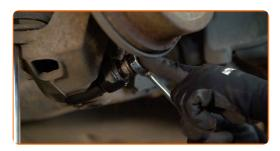
Lösen Sie den unteren Teil des Stoßdämpfers.
