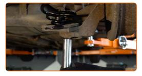
Reinigen Sie die Stoßdämpferaufnahmen. Benutzen Sie WD-40-Spray.
