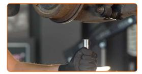
Reinigen Sie die Bremstrommel. Benutzen Sie eine Drahtbürste. Behandeln Sie die Kontaktfläche. Benutzen Sie ein Kupferschmiermittel.
