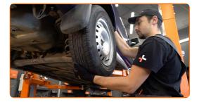
Reinigen Sie die Stoßdämpferbefestigungen. Benutzen Sie eine Drahtbürste. Benutzen Sie WD-40-Spray.
