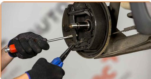
**13** Nehmen Sie die Bremsbelaghaltefedern aus den Löchern heraus. Verwenden Sie Zangen.
