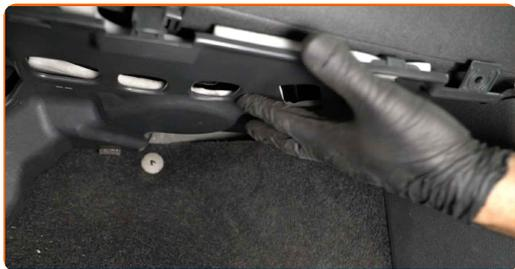
**24** Schraube die Befestigungselemente der unteren Armaturen Brettverkleidung ein. Verwenden Sie den Torx T20.
