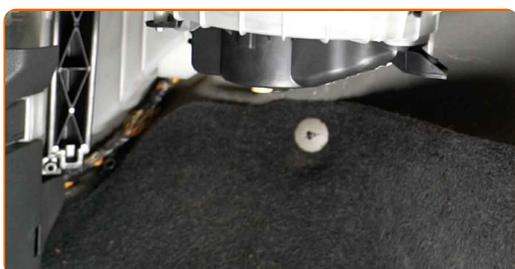
**12** Entfernen Sie den Gehäusedeckel des Innenraumfilters.
