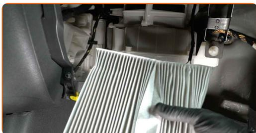
**Austausch: Innenraumfilter – OPEL COMBO Kasten/Kombi (X12). Tipp von AUTODOC:**
