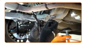
Schneiden Sie das Gewinde für die neue Lambdasonde. Verwenden Sie einen Gewindebohrer. Verwenden Sie einen Ratschenschlüssel.
