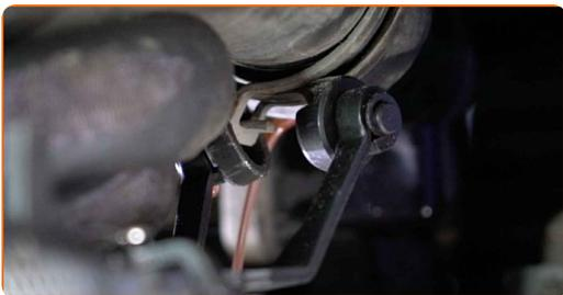
**8** Lösen Sie den Kühlmittelschlauch.
