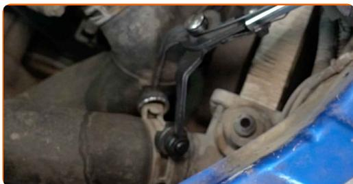
**17** Lösen Sie den Kühlmittelschlauch.
