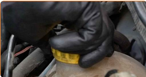
38 Lassen Sie den Motor ein paar Minuten laufen. Dies sollte geschehen, um übriggebliebene Luft aus dem Kühlsystem zu entfernen und zu überprüfen, ob alle Komponenten richtig funktionieren.
