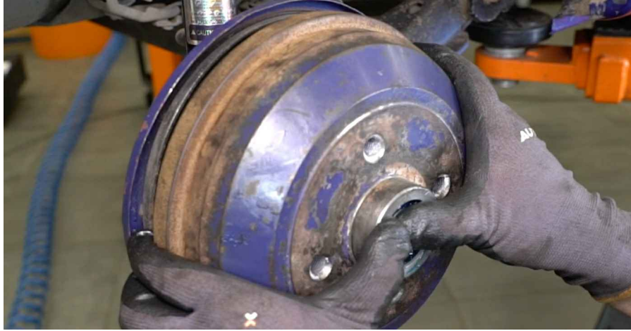
45 Bringen Sie die Unterlegscheibe des Radlagers an.
