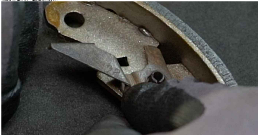
34 Bringen Sie den Sicherungsring an.
