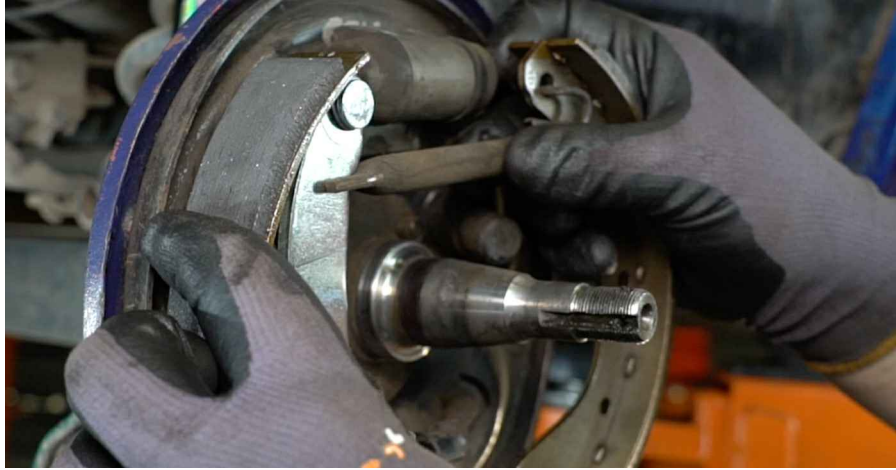
37 Bauen Sie die untere Rückstellfeder ein.
