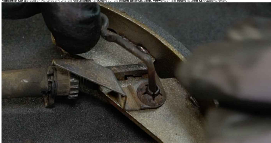
36 Installieren Sie eine neue rechte Bremsbacke.
