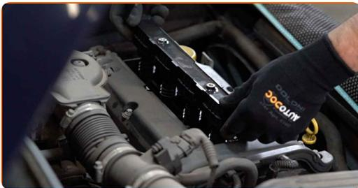
**8** Ziehen Sie die Zündspulen Befestigung an. Verwenden Sie den Torx T30. Verwenden Sie einen Drehmomentschlüssel. Ziehen Sie ihn mit 15 Nm Drehmoment fest.
