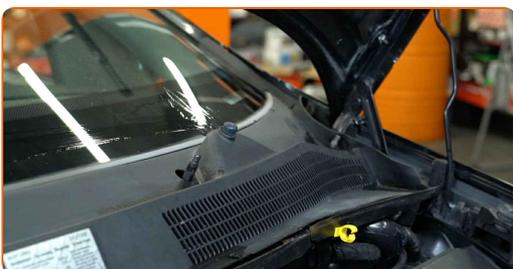
**8** Heben Sie die Windabweiserabdeckung an und entfernen Sie dieses.
