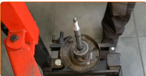
**37** Installieren Sie die Feder am Stoßdämpfer.
