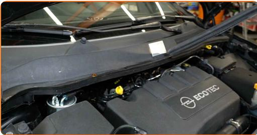
**4** Entfernen Sie die Abdeckungen der Frontscheibenwischerarmmutter. Verwenden Sie einen Lösehebel, um die Clips zu entfernen.
