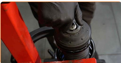
**41** Ziehen Sie die Federbeinkolbenstangenmutter an. Verwenden Sie Stecknuss Nr. 18. Verwenden Sie den Torx T40. Verwenden Sie einen Drehmomentschlüssel. Ziehen Sie ihn mit 50 Nm Drehmoment fest.
