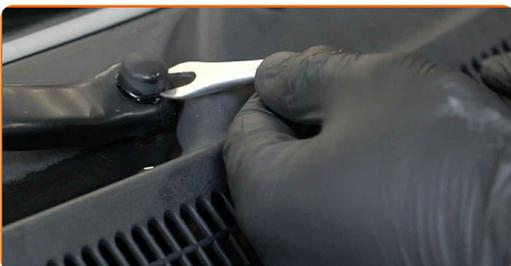
**5** Behandeln Sie die Befestigungen der Wischerarme. Benutzen Sie eine Drahtbürste. Benutzen Sie WD-40-Spray.
