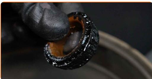
**14** Reinigen Sie den Einbauort für die Nabenlagerung.
