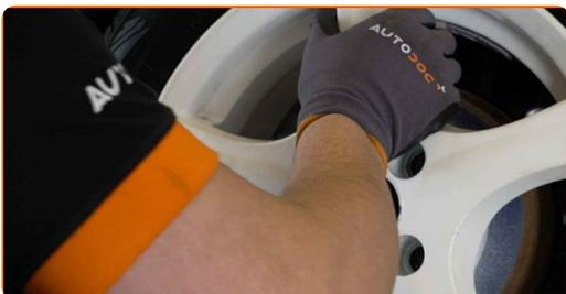
**6** Entfernen Sie die Radnabenkappe. Benutzen Sie ein Brecheisen. Benutzen Sie einen Hammer.
