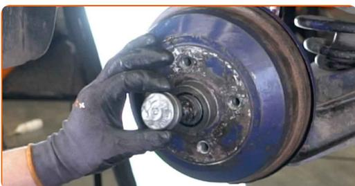
**7** Entfernen Sie den Splint, der die Nabenmutter sichert. Benutzen Sie ein Brecheisen. Verwenden Sie einen flachen Schraubendreher.
