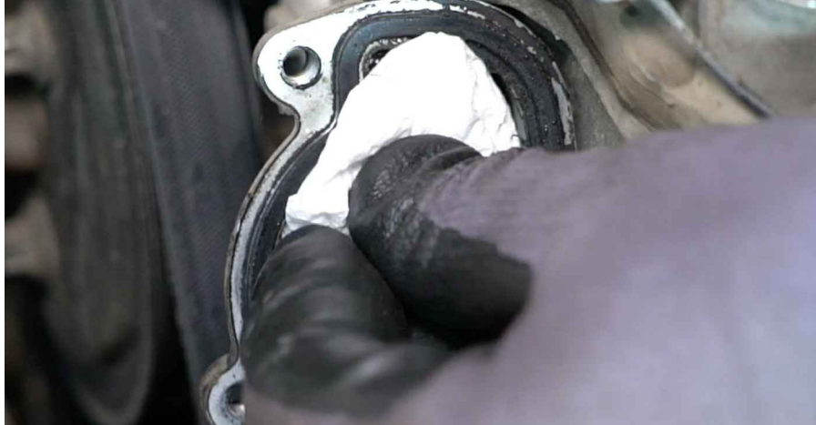
23 Entfernen Sie den Gummistreifen.
