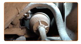
Entfernen Sie die Stabilisatorbuchsenhalter. Benutzen Sie ein Brecheisen.
