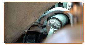
Reinigen Sie die Montagesitze der Stabilisatorbuchsen. Benutzen Sie WD-40-Spray.
