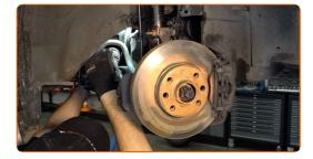
Reinigen Sie die Oberfläche an welcher die Felge montiert werden soll. Benutzen Sie eine Drahtbürste.
