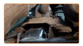
8 Entfernen Sie die Befestigungsschrauben (2 Stück).
