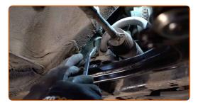
10 Entfernen Sie die Stabilisatorbuchsen.
