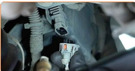
**6** Lösen Sie die Befestigung der Lambdasonde. Verwenden Sie einen offenen Ringschlüssel #22.
