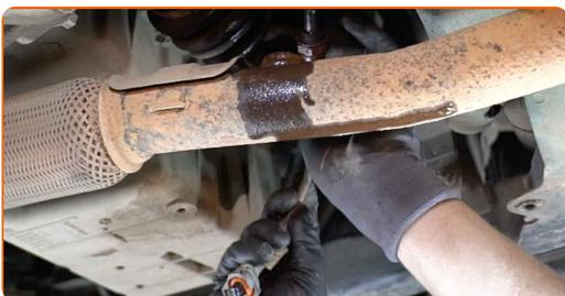
**8** Schneiden Sie das Gewinde für die neue Lambdasonde. Verwenden Sie einen Gewindebohrer. Verwenden Sie einen Ratschenschlüssel.
