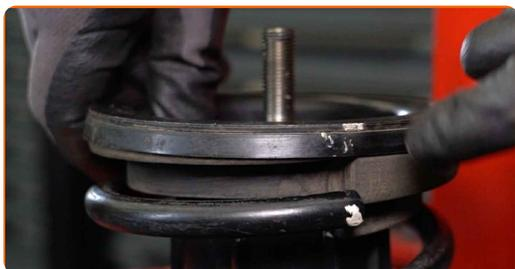
**33** Ziehen Sie die Federbeinkolbenstangenmutter an. Verwenden Sie Inbusschlüssel Nr. H5. Verwenden Sie Stecknuss Nr. 19. Verwenden Sie einen Drehmomentschlüssel. Ziehen Sie ihn mit 55 Nm Drehmoment fest.
