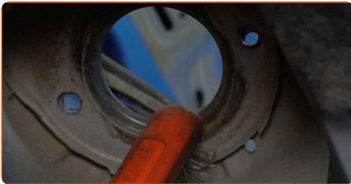
**38** Installieren Sie das Federbein am Radlauf.
