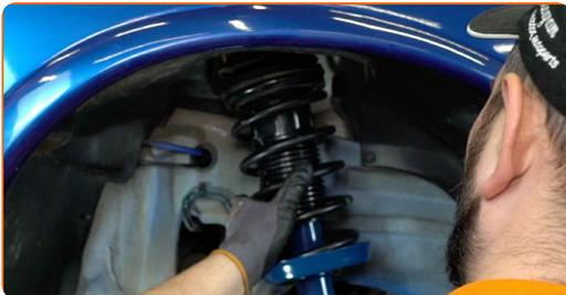
**39** Sichern Sie die oberen Befestigungen des Federbeines. Schrauben Sie diese nicht fest.
