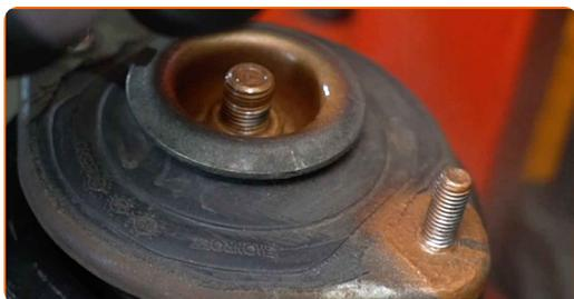
**35** Dekomprimieren Sie die Feder.
