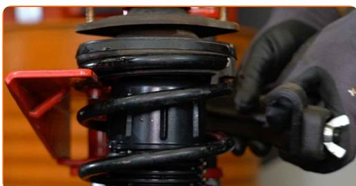
**36** Entfernen Sie das zusammengebaute Federbein.
