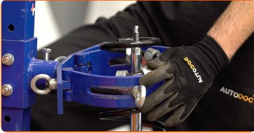
25 Bringen Sie das Stützlager, die Manschette und den Anschlagpuffer auf dem Stoßdämpfer an.
