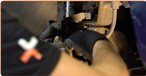
**34** Die neuen Achsschenkelschrauben einbauen.
