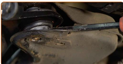
**20** Verbinden Sie den Unterarm mit dem Achsschenkel.
