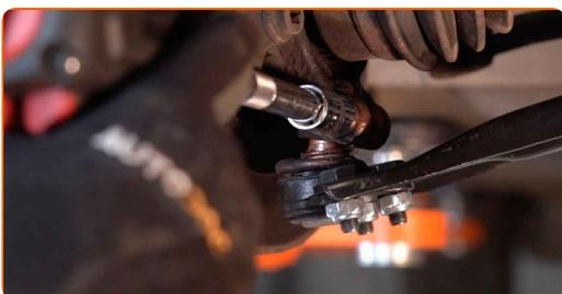
**23** Schrauben Sie die hintere Armbefestigung an. Verwenden Sie die 12-Kant-Stecknuss Nr. 22.
