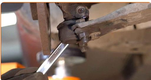
**8** Entfernen Sie die Befestigungsschraube.
