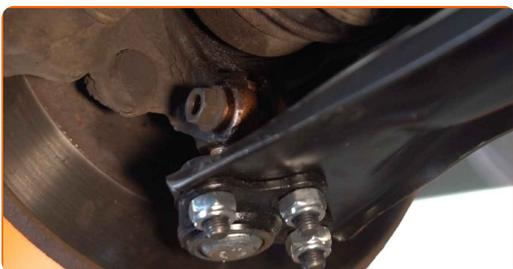
**22** Schrauben Sie die Befestigungen des Kugelgelenks ein. Verwenden Sie Stecknuss Nr. 16. Verwenden Sie einen Ratschenschlüssel.
