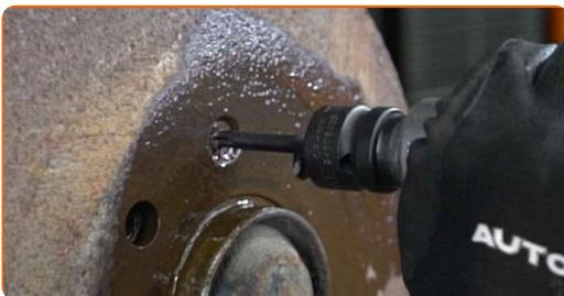
**8** Entfernen Sie die Befestigungsschrauben.
