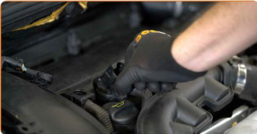
**4** Heben Sie die Zündspule an. Benutzen Sie ein Brecheisen. Entnehmen Sie die Zündspule aus der Vertiefung für die Zündkerze.
