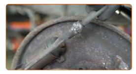
Entfernen Sie die Feststellbremsen-Haltefeder der linken Bremsbacke. Verwenden Sie einen flachen Schraubendreher.
