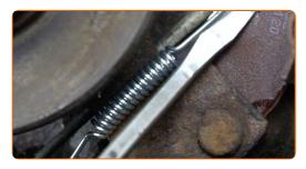
Installieren Sie die Feststellbremsen-Haltefeder der linken Bremsbacke.
