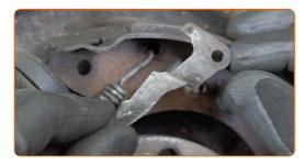
Lösen Sie den Nachsteller der Bremsbacken. Verwenden Sie einen flachen Schraubendreher.
