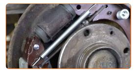
Montieren Sie den Einstellhebel.
