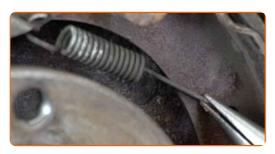
15 Entfernen Sie den Einstellhebel.
