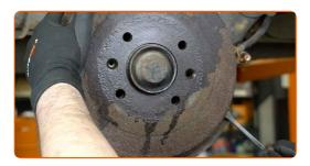
Reinigen Sie die Befestigungen der Bremsbacken. Benutzen Sie eine Drahtbürste. Benutzen Sie einen Bremsenreiniger.
