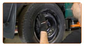
Reinigen Sie die Bremstrommelbefestigungen. Benutzen Sie eine Drahtbürste. Benutzen Sie WD-40-Spray.
