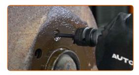
Entfernen Sie die Befestigungsschrauben.
