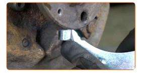
Installieren Sie eine neue linke Bremsbacke.
