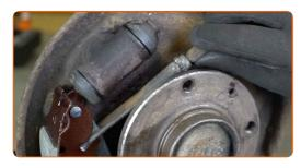
Installieren Sie eine neue rechte Bremsbacke.
