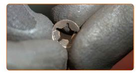
Verbinden Sie das Festellbremskabel mit dem Feststellbremshebel.
