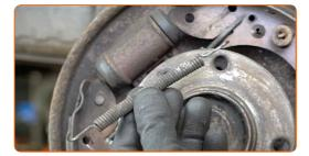
Entfernen Sie die Halterung der Trommelbremsbacken. Verwenden Sie ein Bremsfeder-Montagewerkzeug.
