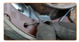
Reinigen Sie die Nabe. Benutzen Sie eine Drahtbürste.
