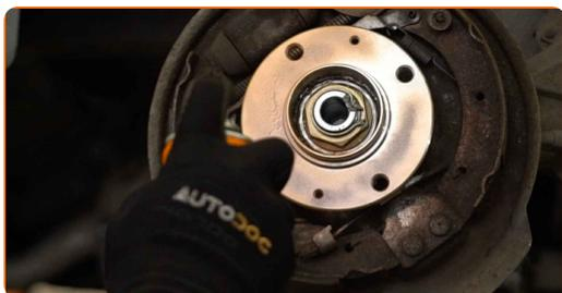
**18** Installieren Sie die Schutzkappe des Nabenlagers. Verwenden Sie einen Gummi-Hammer.
