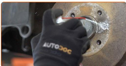
**7** Schrauben Sie die Bremstrommel-Befestigung ab. Verwenden Sie den Torx T30. Verwenden Sie einen Schlagschrauber. Benutzen Sie einen Hammer.
