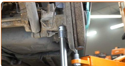
**7** Reinigen Sie die Stoßdämpferbefestigungen. Benutzen Sie eine Drahtbürste. Benutzen Sie WD-40-Spray.
