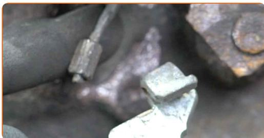
**23** Entfernen Sie die linke Bremsbacke.
