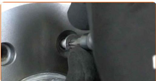
**41** Ziehen Sie die Bremstrommelbefestigungen an. Verwenden Sie den Torx T30. Verwenden Sie einen Drehmomentschlüssel. Ziehen Sie ihn mit 10 Nm Drehmoment fest.
