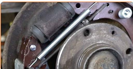
**32** Montieren Sie den Einstellhebel.
