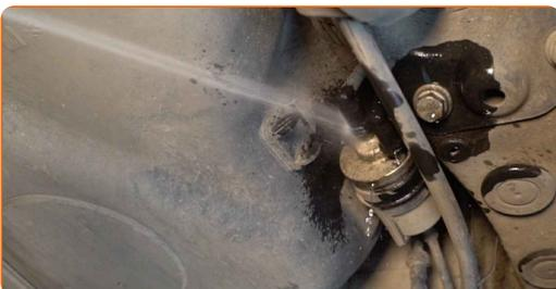
**6** Trennen Sie die Kraftstoffversorgungsleitungen vom Kraftstofffilter. Benutzen Sie ein Brecheisen.
