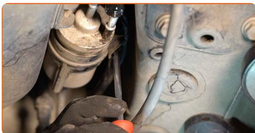
**8** Reinigen Sie die Kraftstoffleitungen. Verwenden Sie Allzweckreinigungsspray.
