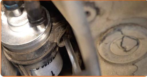
**14** Den Flüssigkeitsbehälter unter dem Kraftstofffilter entfernen.
