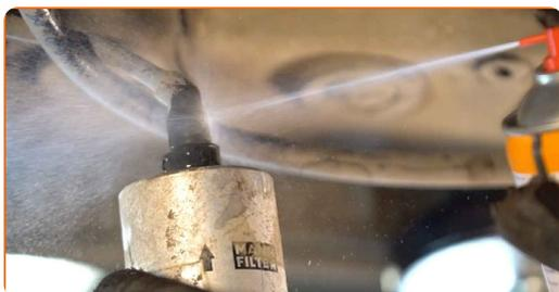
**9** Trennen Sie die Kraftstoffversorgungsleitungen vom Kraftstofffilter. Benutzen Sie ein Brecheisen.
