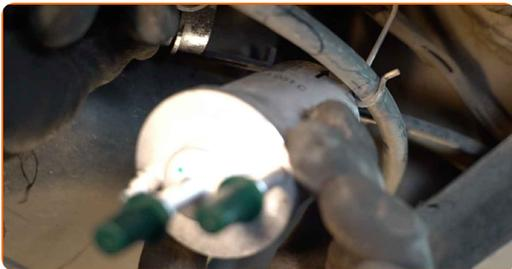
**13** Ziehen Sie die Befestigungsmittel des Treibstofffilters fest. Verwenden Sie einen Kreuzschlitzschraubendreher.
